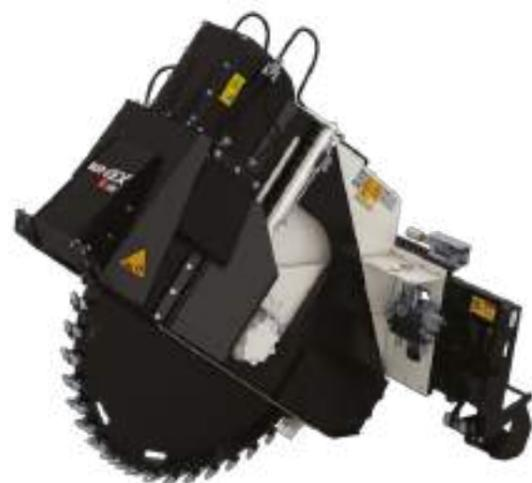
Progettate per montaggio su pale e minipale, le ruote escavatrici Simex offrono diverse soluzioni per **lavorare su sperfici dure o compatte** come asfalto, cemento e roccia: tagli e piccoli scavi, scavi a sezione predefinita, **minitrincee e microtrincee per la posa di cavi in fibra ottica**.
