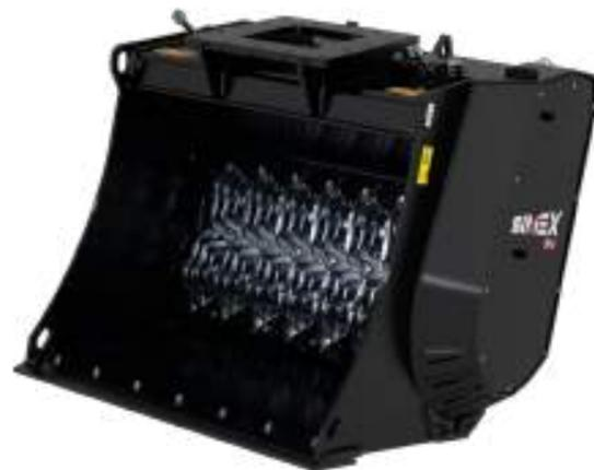
Progettate per la **separazione dei materiali di diversa pezzatura** direttamente in cantiere, le benne vagliatrici Simex VSE si distinguono per il **facile caricamento**, per la **grande semplicità d'uso** e per l'**elevata produttività**.
