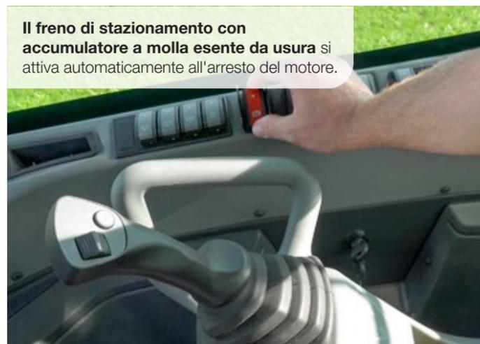
**Il freno di stazionamento con accumulatore a molla esente da usura** si attiva automaticamente all'arresto del motore.
