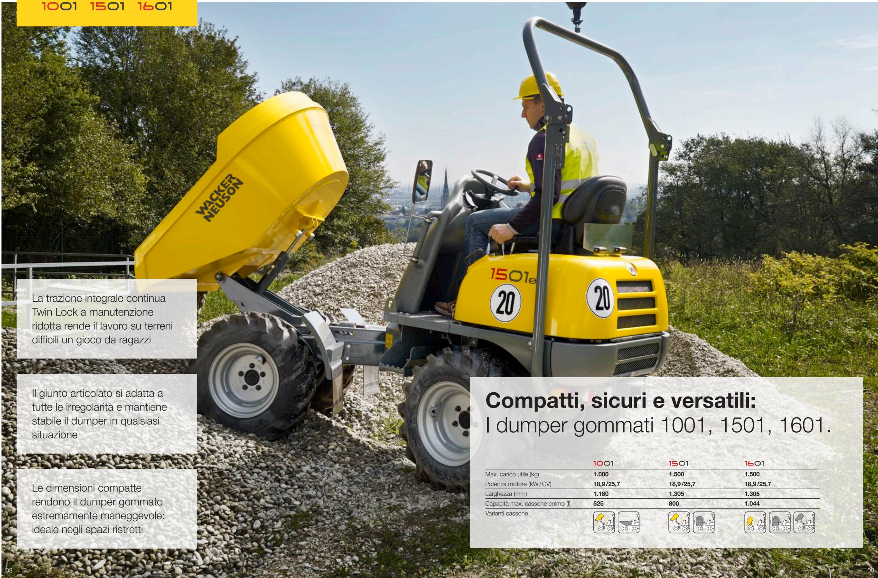
La trazione integrale continua Twin Lock a manutenzione ridotta rende il lavoro su terreni difficili un gioco da ragazzi
